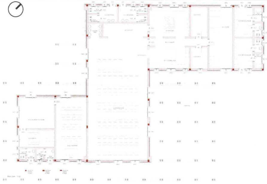
Pianta del piano terra dell'edificio servizi: lavanderia, stiroeria, cucina, biblioteca, aula didattica, sala giochi per i bambini, magazzini, mensa staff.
